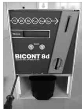
**3** Abaissez maintenant la face frontale d'env. 2 cm puis la retirer avec précaution hors du boîtier. Déconnectez le câble qui relie la face frontale avec l'unité de commande à l'arrière de la face frontale. Veillez à actionner le verrouillage de la fiche afin de pouvoir la retirer.
