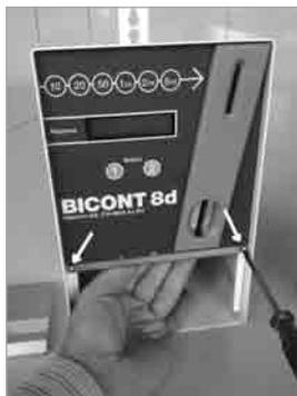
**2** Dévissez les deux vis de chaque côté avec un tournevis cruciforme et maintenez la face frontale dans cette position avec une main.
